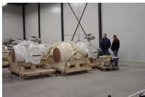
30" All welded Cameron Valves in Wegman magazijn
